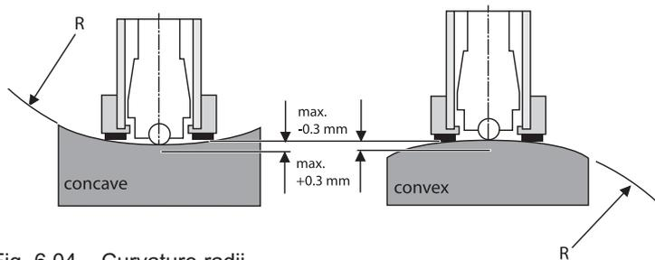
Fig. 6.04 Curvature radii
